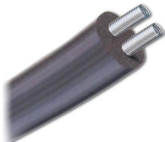
Tubazione di andata e ritorno in acciaio inox AISI 316, flessibile preisolata in elastomero a cellule chiuse silconico per allacciamento della sonda solare. Massima semplicità di collegamento. Lunghezza 20 metri. Completa di raccordi.
