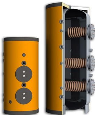
**BC:** Accumulo **smaltato** per modelli da 200 a 1000, accumulo **ceramplast** per modelli da 1500 a 5000, sistema di protezione anticorrosione, isolamento rigido per modelli da 200 a 1000 ed isolamento flessibile per i modelli da 1500 a 5000.
