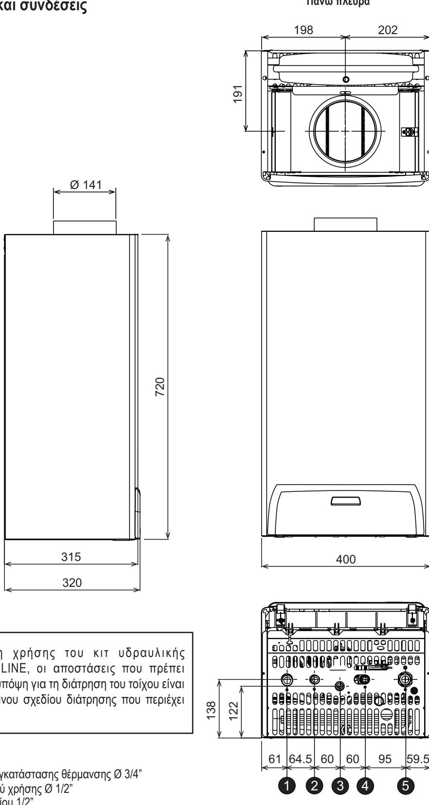
Σε περίπτωση χρήσης του κιτ υδραυλικής σύνδεσης LEJ LINE, οι αποστάσεις που πρέπει να λαμβάνονται υπόψη για τη διάτρηση του τοίχου είναι εκείνες του χάρτινου σχεδίου διάτρησης που περιέχει το KIT
